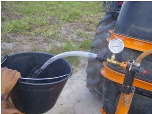
Detalhe : coleta da vazão realizada para conferência da calibração
