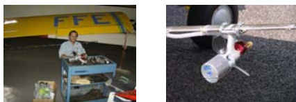
Fotos 1 e 2: Preparo dos bicos para montagem, e bico já instalado na barra do avião.
