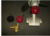
Foto 09: Detalhe da unidade reguladora de vazão "V07" do ASC-A10, desmontada
