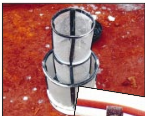
Figura 8 - Alguns problemas comuns em pulverizadores avaliados: filtros danificados, antigotejo com vazamento e escorrimento no patim de arraste
