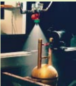
Figura 5 - Analisador de gotas a laser PMS
