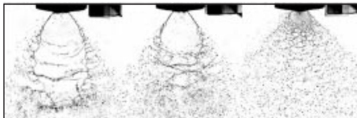
Figura 6 - Formação do Spray por uma ponta leque plano, com surfactante a 0,5%, água pura e formulação de emulsão 0,5%. (ELLIS, 2003)
