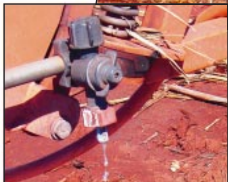
Figura 8 - Alguns problemas comuns em pulverizadores avaliados: filtros danificados, antigotejo com vazamento e escorrimento no patim de arraste
